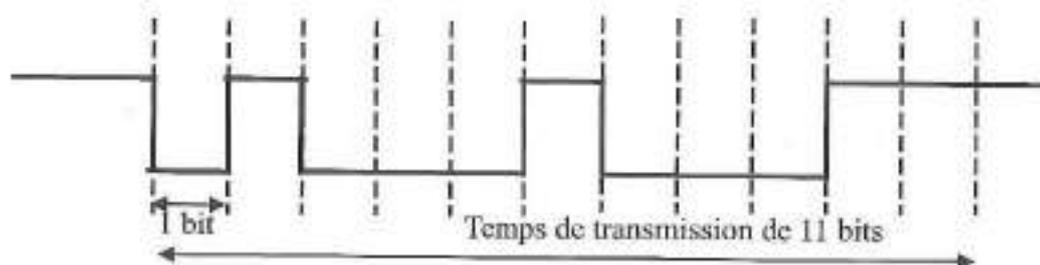
Sur la liaison série de la **FIGURE 1** entre PC-A2 et AP-A4, on relève le chronogramme binaire ci-dessus. La vitesse de transmission observée est de 19200 bits/s. Quel est le temps de transmission d'une suite de 11 bits consécutifs :
