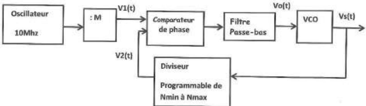
On appelle  $F_1$ ,  $F_2$ , les fréquences respectives de  $V_1$ ,  $V_2$  (entrée de la PLL),  $F_s$  fréquence de  $V_s$  (sortie de la PLL),
