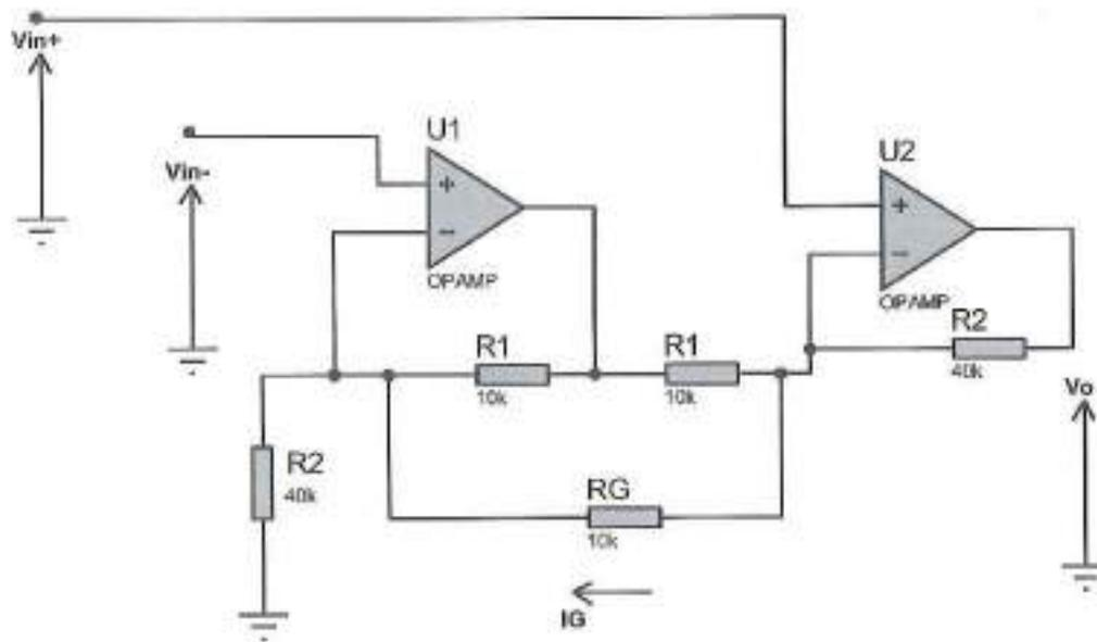
Les Amplificateurs opérationnels sont considérés idéaux et  $R1=10k\Omega$ ,  $R2=40k\Omega$ .
