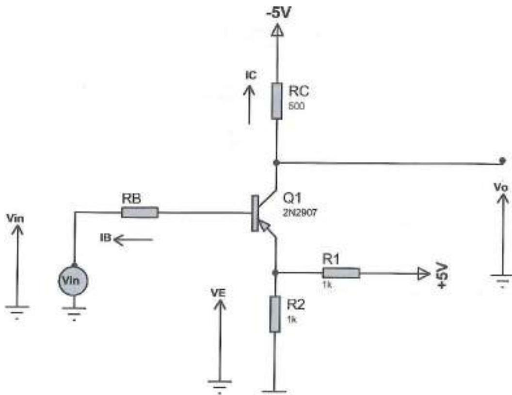
Pour les calculs on remplacera le transistor entre collecteur et émetteur par un interrupteur fermé lorsque le transistor est saturé et par un interrupteur ouvert lorsque le transistor est bloqué.
