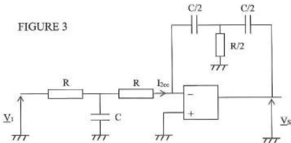
La fonction de transfert  $\frac{V_s}{V_1}$  complexe du circuit de la Figure 3 est égale à :
