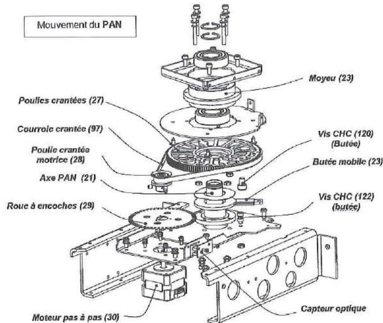
Figure 1: éclaté de la motorization de l'axe PAN
