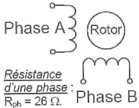
Figure 2: structure des moteurs PAN et TILT
