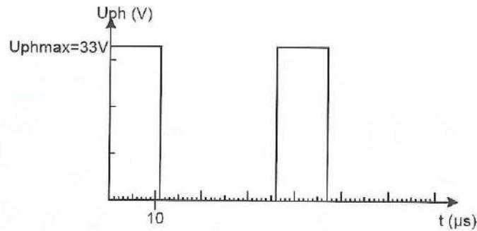
Figure 12 : tension aux bornes d'une phase du moteur
