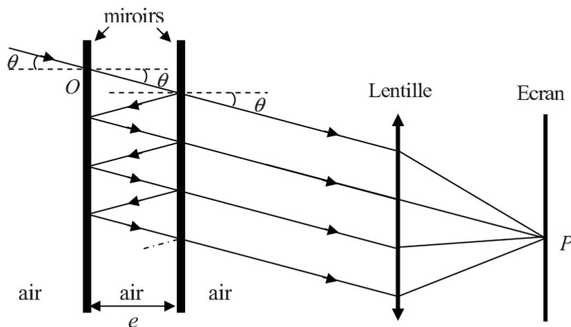
Figure 7 – Interféromètre de Fabry – Pérot
