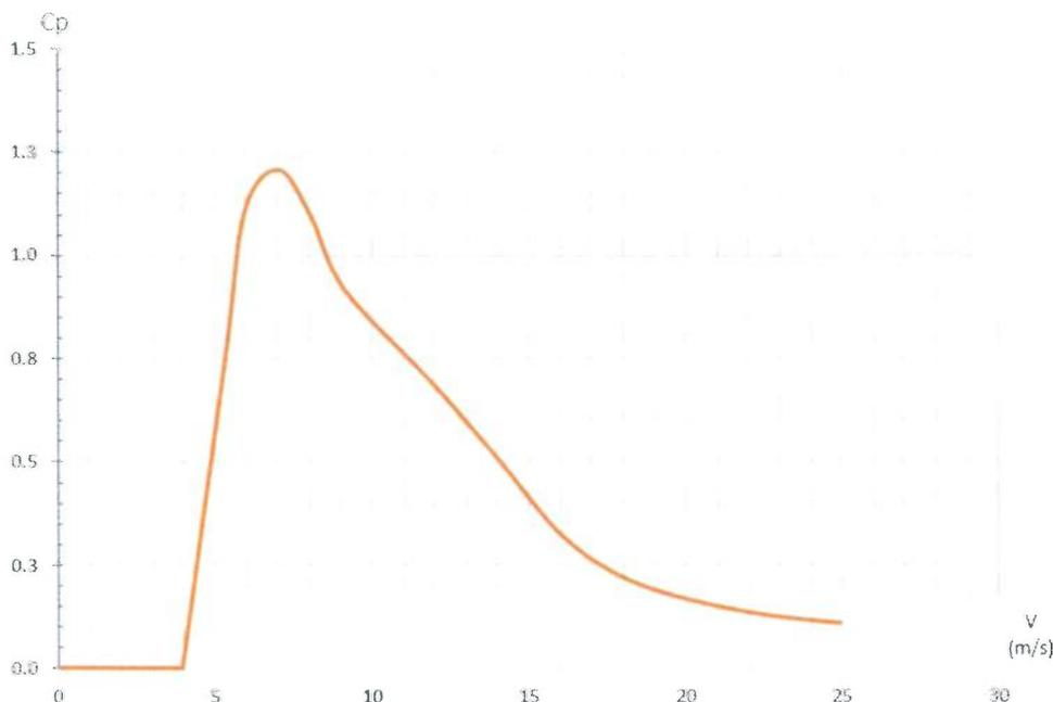
Figure 3 : Courbe du coefficient de puissance  $C_p$  en fonction de la vitesse du vent  $V$
